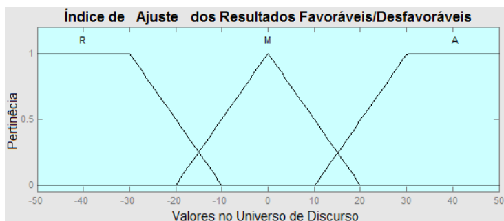
Fig. 6. Funções de pertinência do Índice de Ajuste dos Resultados Favoráveis e Desfavoráveis.
