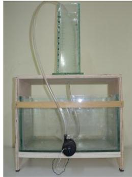
Figura 1. Sistema de Tanques a ser Controlado
