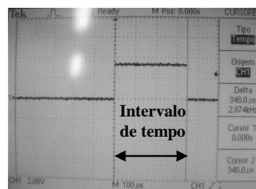
**Figura 4. Imagem ilustrativa da medição do tempo de execução no osciloscópio.**
