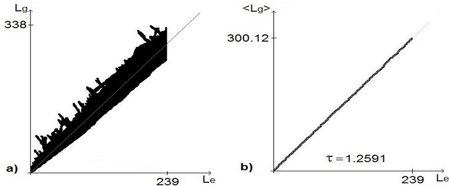
**Figura 2. a) Gráfico da distribuição de distâncias e b) gráfico de  $L_E \times \langle L_G \rangle$ , com o valor da tortuosidade para a amostra 266.**
