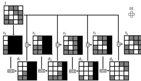
**Figura 3. Esquematização do funcionamento do algoritmo de RG para uma imagem bidimensional  $4 \times 4$  pixels. Note que o pixel isolado no canto superior direito é eliminado durante o procedimento.**
